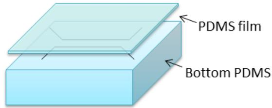
Figure 1: PDMS device structure
